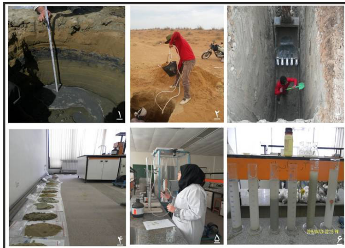
شکل ۶. حفر چاهک شماره ۵ و ۱ به صورت دستی (۱ و ۲) و شماره ۴ با بیل مکانیکی (۳)، خشک کردن نمونه‌ها در هوای آزاد (۴)، آزمایش‌های کلسی‌متری (۵) و هیدرومتری (۶)
