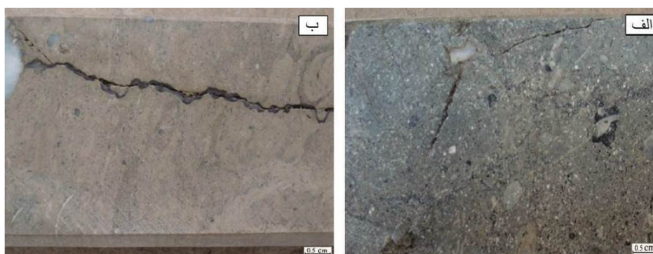
شکل ۸. الف) شکستگی‌هایی که منجر به ایجاد تخلخل در مغزه‌های سازند آسماری شده است. ب) شکستگی منطبق بر استیلولیت
