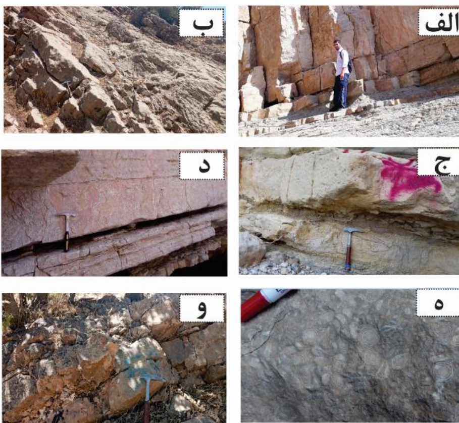
شکل ۴. واحدهای سنگ‌چینه‌ای سازند تله‌زنگ در برش مورد مطالعه، الف) سنگ‌آهک ضخیم لایه و صخره‌ساز در تماس با سازند امیران، ب) سنگ‌آهک نازک تا متوسط لایه خاکستری روشن، ج) سنگ‌آهک متوسط لایه به رنگ خاکستری روشن، د) سنگ‌آهک متوسط تا ضخیم لایه، ه) سنگ‌آهک حاوی فسیل بنتیک فراوان، و) سنگ‌آهک ماسه‌ای نازک لایه خاکستری روشن تا کمی تیره مربوط بخش بالایی سازند تله‌زنگ.
