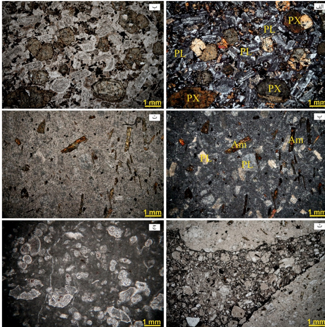
شکل ۵. منتخبی از تصاویر میکروسکوپی مقاطع نازک گراول‌های سازند کرمان، (الف) بازالت حاوی بلورهای پلاژیوکلاز جهت‌یافته (PL) و کلینوپیروکسن (PX)، نور پلاریزان و (ب) نور معمولی؛ (پ) آندزیت حاوی بلورهای کشیده آمفیبول (Am) به رنگ قهوه‌ای، پلاژیوکلاز سانیدین (PL) و زمینه شیشه، نور پلاریزان و (ت) نور معمولی؛ (ث) توف آگلومرا در نور معمولی؛ (ج) سنگ آهک گلوبوترونکانادار در نور معمولی.
