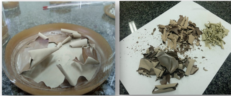
شکل ۴. تصاویر نمونه‌های گل خشک شده مرتبط با گل‌فشان‌های منطقه سیوان. خاصیت ورقه‌ای شدن بیانگر مقدار قابل توجهی رس درون نمونه‌ها است. Fig. 4. Photos of dried mud samples related to mud volcanoes of Seivan area. Fissility indicates a significant amount of clays in samples.
