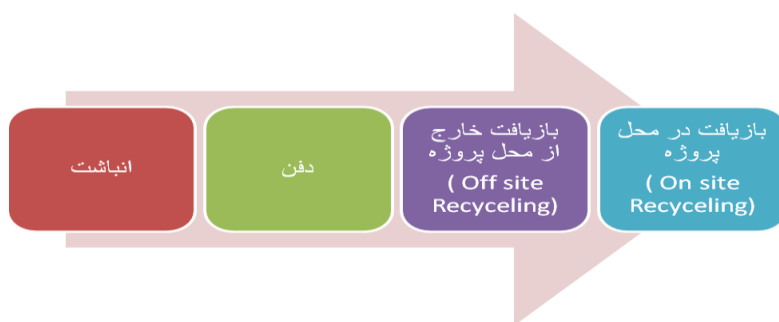
شکل ۱. سیر تکاملی مدیریت نخاله‌های ساختمانی در مناطق شهری Fig. 1. Evolution of Construction Waste Management in Urban Areas
