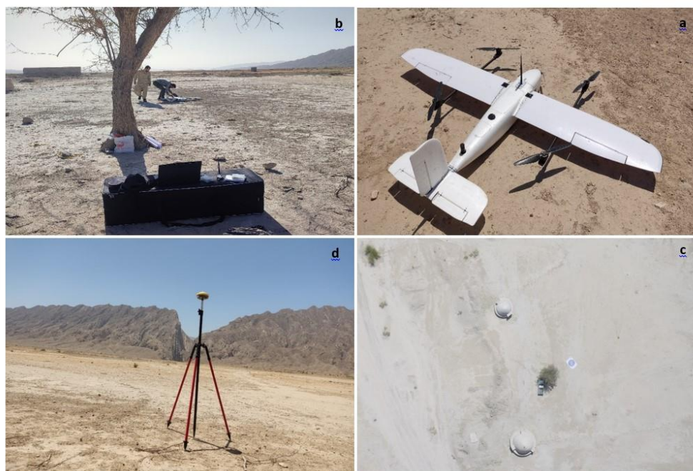
شکل ۴. تصاویری از مراحل تصویربرداری با پهپاد (a: پهپاد SAHAB E2 مورد استفاده در تصویربرداری، b: آماده‌سازی پهپاد جهت پرواز، c: تصویر پهپاد از ایستگاه کنترل زمینی و d: گیرنده GNSS برداشت استاتیک به عنوان مرجع محاسبات PPK)
