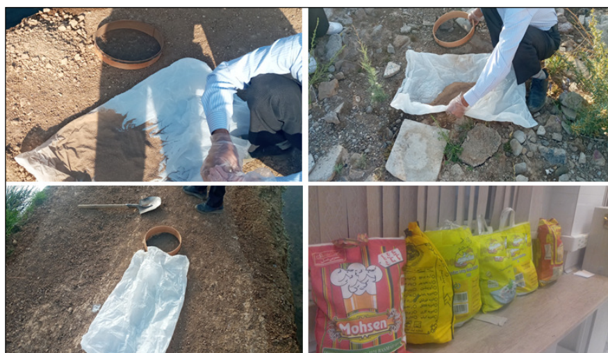
شکل ۴. عملیات نمونه‌برداری و بخشی از رسوبات جمع‌آوری شده از کف کانال رودخانه برای آنالیز دانه‌بندی
