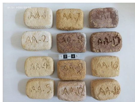
شکل ۱۲. تنوع رنگی ناشی از حضور اکسیدهای آهن و کلسیم در آجرهای تولید شده در دمای ۱۱۰۰ درجه سانتی‌گراد
